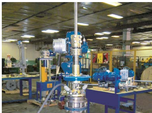
Участок сборки и испытаний оборудования для резки в трубопровод
